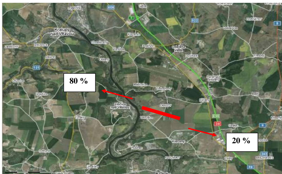
Obr. 4 Využití směrů RWY v celoročním leteckém provozu LKVO
